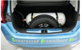
ワゴンRのトランクに搭載のCNGタンク
