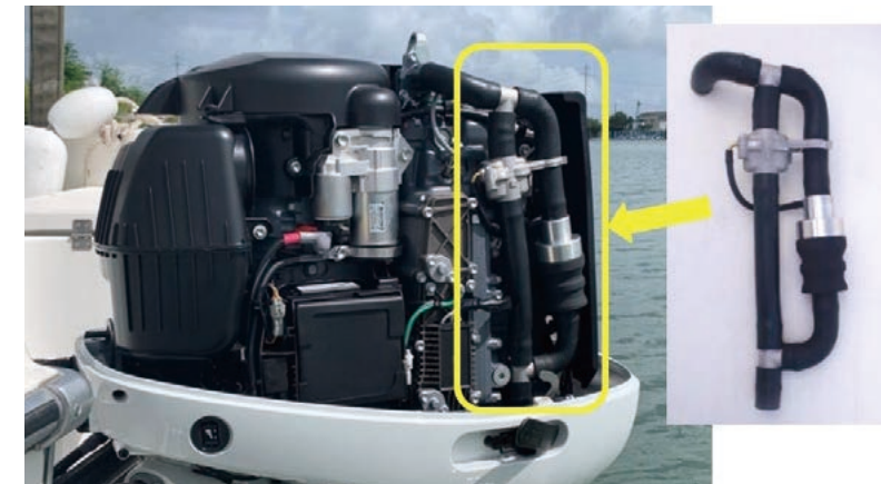
マイクロプラスチック回収装置を取り付けた船外機
